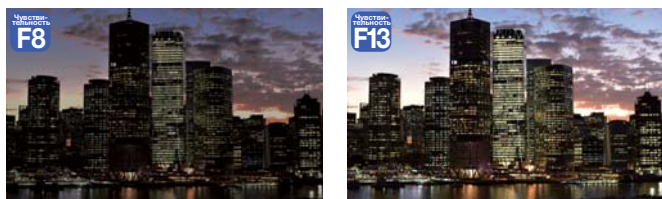
Сравните яркость изображения при съемке в условиях освещенности 2000 лк: чувствительности F8 (слева) у обычной камеры и F13 (50 Гц) у камеры GY-HM660.
